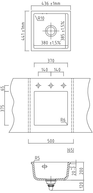
Wir empfehlen, aufgrund der werkstoffbedingten Toleranzen von +/- 1,5% den Ausschnitt anhand des gelieferten Beckens zu fertigen.
