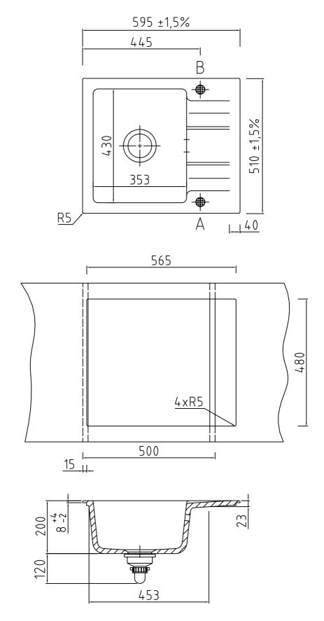
Keine Armaturbohrung vorhanden. Keine Sollbruchstellen. Bohrungen nach individueller Anordnung (
