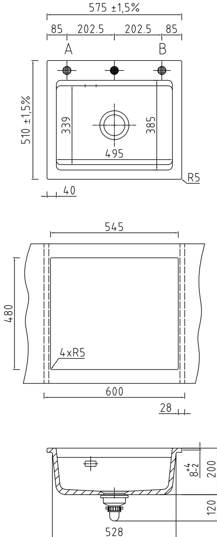
● Armaturbohrung vorhanden. Keine Sollbruchstellen.
