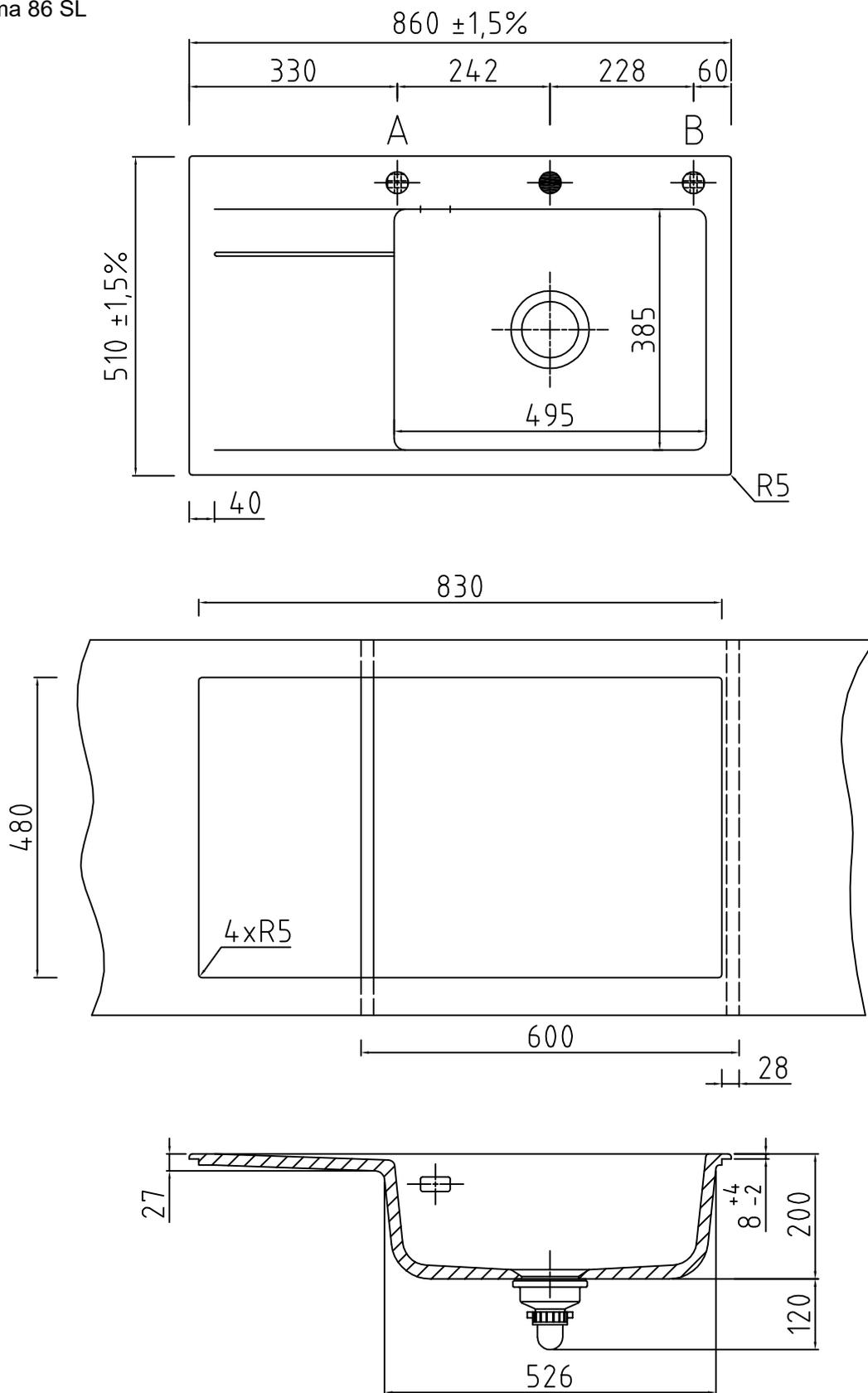
● Armaturbohrung vorhanden. Keine Sollbruchstellen.
