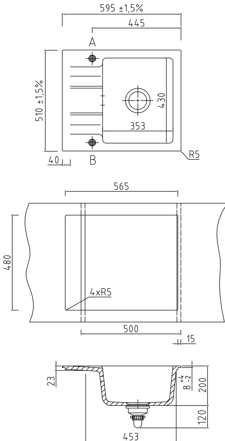
Keine Armaturbohrung vorhanden. Keine Sollbruchstellen. Bohrungen nach individueller Anordnung (● Pos. A und B, siehe Zeichnung).
