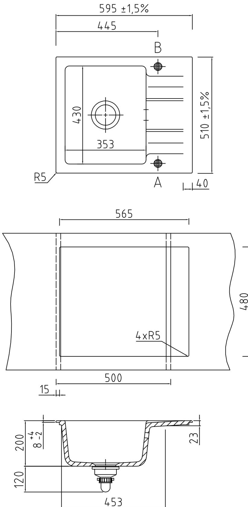
Keine Armaturbohrung vorhanden. Keine Sollbruchstellen. Bohrungen nach individueller Anordnung (● Pos. A und B, siehe Zeichnung).
