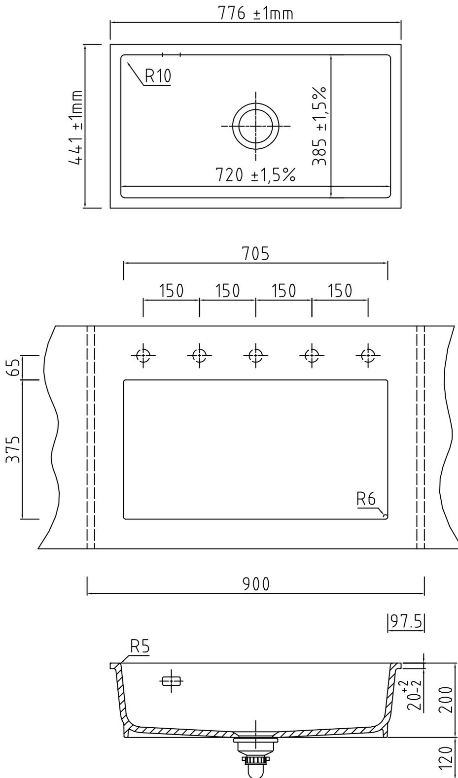
Wir empfehlen, aufgrund der werkstoffbedingten Toleranzen von  $\pm 1,5\%$  den Ausschnitt anhand des gelieferten Beckens zu fertigen.
